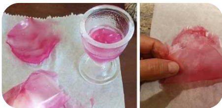
Biokunststoff aus Kartoffelstärke beim Trocknen
